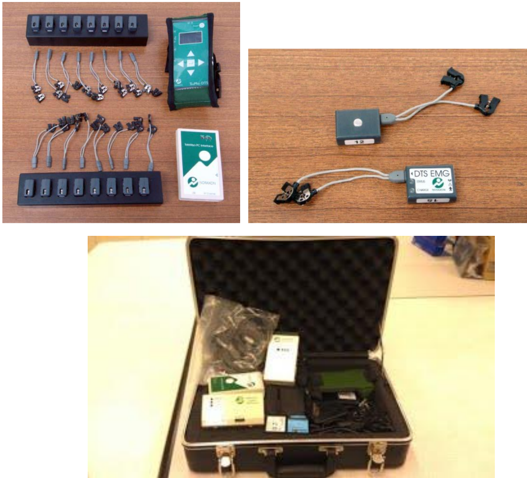
圖 4 無線表面肌電儀量測系統
